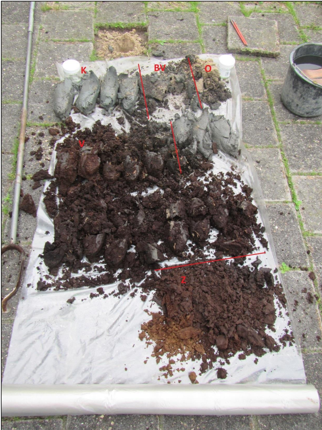
Afbeelding 14. Boring 7: O: opgebracht zand; BV: voormalige bouwvoor; K: klei; V: veen; Z: dekzand
